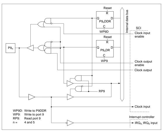
Figure C-8 (d) Port 9 Block Diagram (Pin P9<sub>4</sub>, P9<sub>5</sub>)
